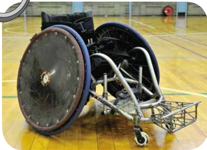
車いすラグビー用 (ディフェンス型) 相手をブロックするためバンパーが飛び出している
