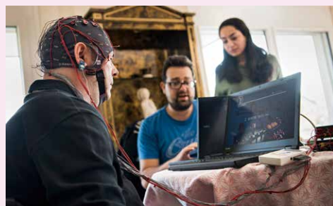
脳波をコンピュータに電送する装置を装着し、コンピュータ上でアバターを操作している様子(写真提供：EPA＝時事)
