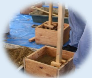
版築によるブロック製作
