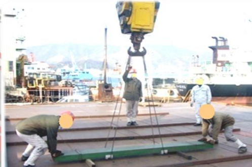
有井作業場 玉掛作業
